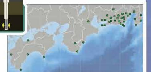
プレート境界のゆっくりすべりなどに伴うごくわずかな岩盤の伸び縮みを捉えるため、気象庁はひずみ計による地殻変動の観測網を展開し、産業技術総合研究所、静岡県のみずみ計データと共に常時監視を行っています。
